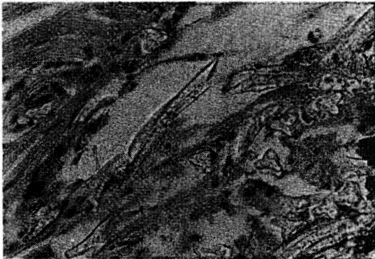
図3 Dacron filament の変形、やせ
